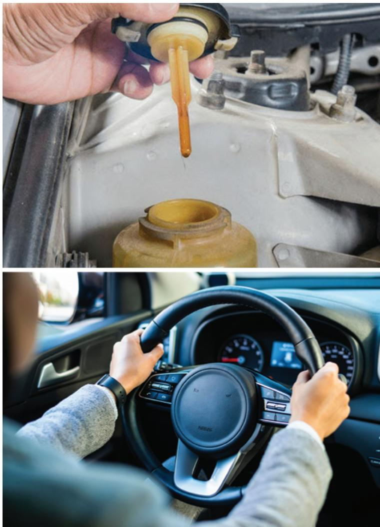
**Figura 28.** Revisión del líquido hidráulico
