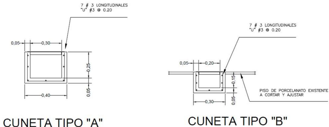
NOTA: TANTO LA CUNETETA TIPO "A" COMO LA "B" DEBEN LLEVAR UNA PARRILLA CON MARCO DE ANGULAR DE 1.8x25x25 mm Y CUBIERTA DE JORDOMEX, DEBIDAMENTE APOYADO PARA QUE NO SE DEFORME CON EL TRANSITO.
