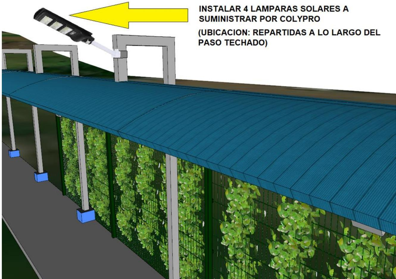
*Imagen 6. Detalle instalación de lámparas en paso techado.*
