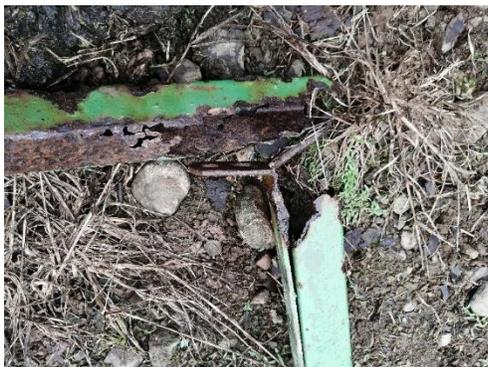
Fotografía #9. Estado de corrosión de algunas piezas del portón.
