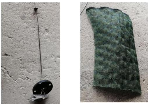
Fotografía #1. Sistema Mirafi® TM13C y TM14S para reforzamiento de suelo en taludes llevado al sitio por el proveedor. Muestra el sistema de anclaje al suelo a reforzar y la geomanta.
