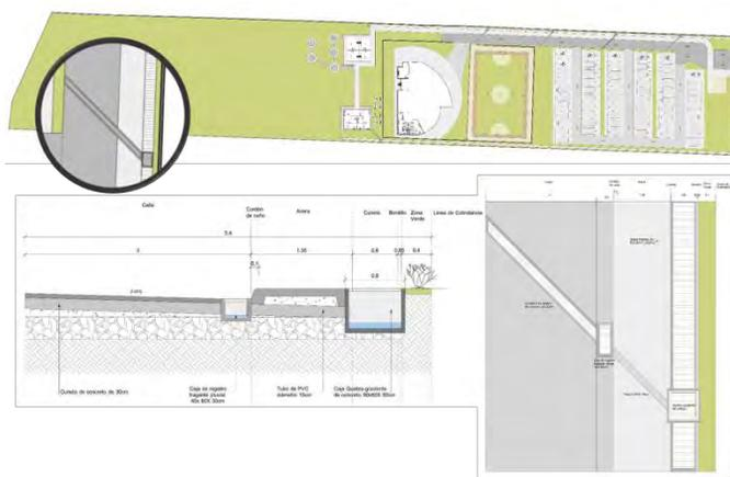
03. Sistema de alcantarillado pluvial Propuesta de Diseño
